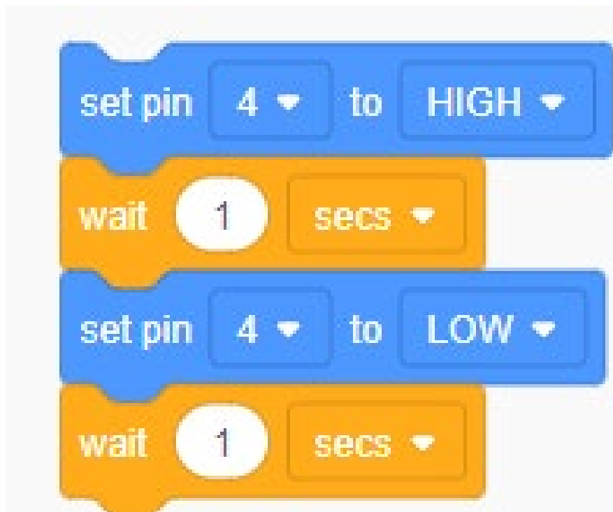
Εικόνα 3: Κώδικας με πλακίδια που επιτρέπει στο λαμπάκι LED να αναβοσβήνει για ένα δευτερόλεπτο.
